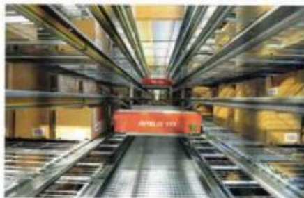
Un système à navettes haute cadence de type goods-to-man Intelis PTS, conçu par Savoye, est en cours d'installation sur la future plateforme de Veauche des Papeteries Pichon (groupe Manutan).
